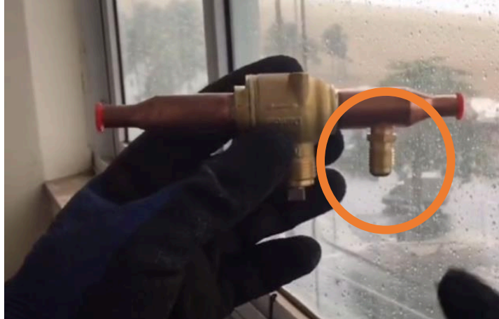
Válvula tipo GBC com destaque para a válvula schrader para drenagem do gás da evaporadora.
